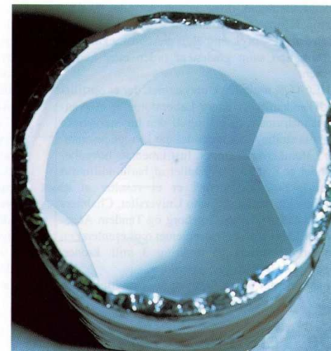
Verdens største énkrystal af bariumdifluorid. HECTOR består af 8 sådanne scintillations detektorer, der omdanner gamma strålers energi til lys. Det særlige ved disse detektorer er, at de kan give information om tidspunktet for strålingens ankomst med en nøjagtighed på omkring en halv milliardtedel sekund.
