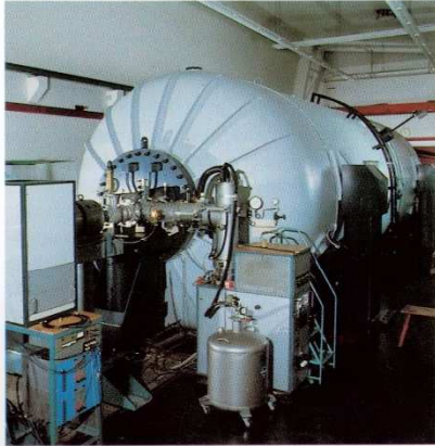
Tandem acceleratoren. Den store tryktank er fyldt med en isolerende gas ved 10 atmosfæres tryk. Hermed kan der opretholdes en spænding på op til 10 millioner volt mellem terminalen i midten af acceleratoren og maskinens ender.
