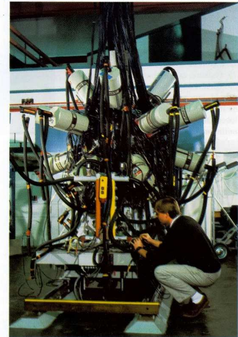
NORDBALL i opbygningsfasen. De mange forskellige detektorer, som NORDBALL består af fastspændes på en ramme med 32 felter, der har samme form som en fodbold. Alle detektorer er modulært opbygget, således at NORDBALL nemt kan ombygges til forsøg der kræver andre detektorer.
