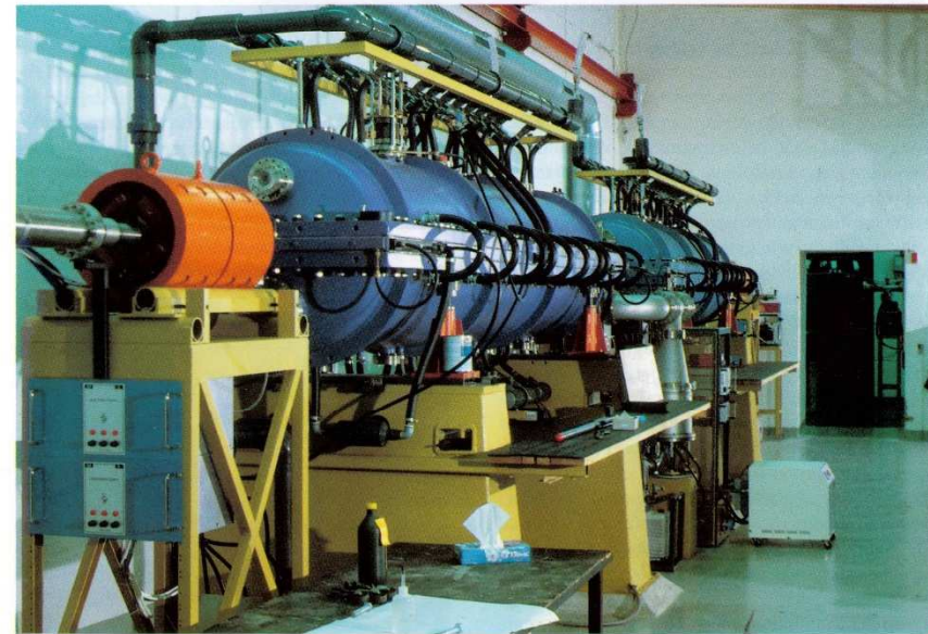
Den nye efteraccelerator har to tanke, som i modsætning til tandemacceleratoren, er lufttomme. Når partikler fra tandemacceleratoren passerer igennem efteracceleratoren fordobles deres energi.
