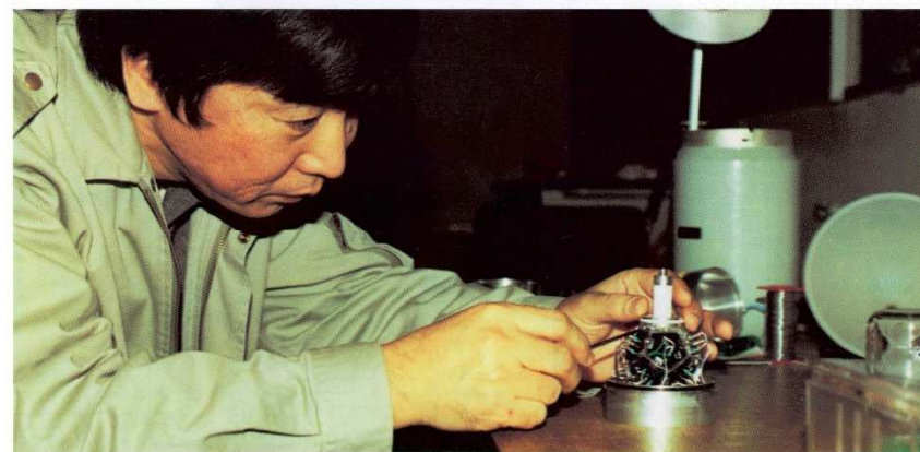
Shiro Mitarai, fra Kyushu Universitetet i Japan, er ved at samle den mindste af de tre detektorkugler, som NORDBALL består af. Denne detektor består af 24 silicium skiver til måling af de protoner og alfa partikler, der udsendes ved kernereaktionerne.
