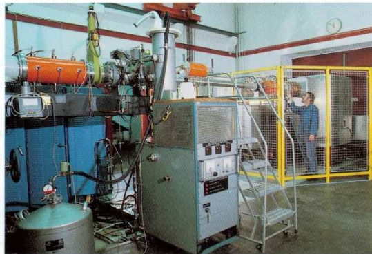
Acceleratorens ionkilde og injektor er omgivet af et bur, da de befinder sig på højspænding. Ionerne forlader injektoren gennem et vakuumrør, hvorpå de skydes ind i Tandemacceleratoren til venstre.
